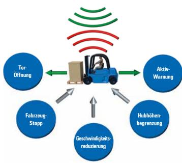
Der NoColl Dome/v2 steuert die Fahrzeugfunktionen vom Fahrerschutzdach aus. Mit einem Leuchtring zeigt er den Status der Fahrzeugbeeinflussung nach außen weit sichtbar an. Die integrierte Elektronik ist mikroprozessorgesteuert zur redundanten Signalverarbeitung.
