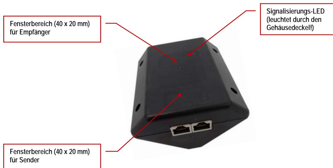
Die Signalisierungs-LED blinkt bei Normalbetrieb ohne Empfang regelmäßig „grün“ mit 1 Hz. Bei Signalempfang von einem anderen Sensor flackert die LED unregelmäßig.
